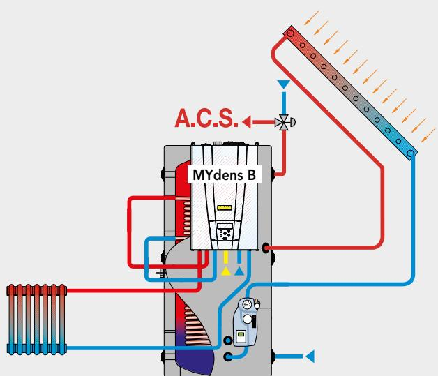
**MYdens** può essere abbinata a zaino ad un bollitore a doppio serpentina con anodo elettronico di serie, dando vita ad un produttore autonomo di A.C.S. collegabile ad impianto solare. È la soluzione ideale in presenza di elevate richieste di punta di acqua calda e riscaldamento. Non necessita di locale adibito a centrale termica.
