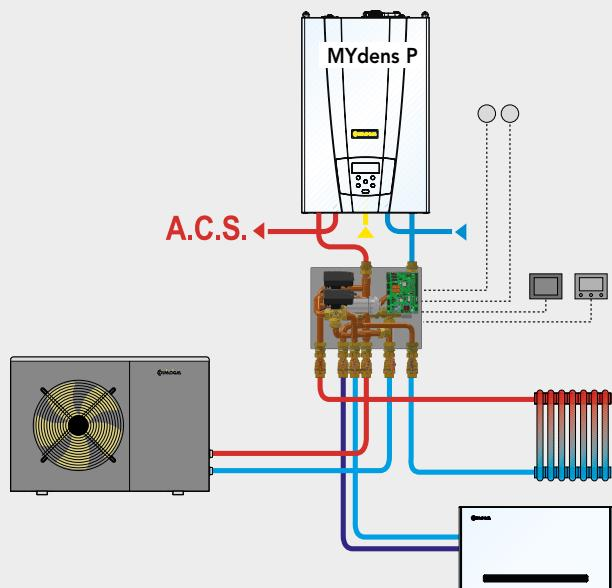
**MYdens** è inseribile nel sistema ibrido "Factory-Made" ECOhybrid, con la pompa di calore collegata si ottimizza l'efficienza dell'impianto ed il risparmio energetico.
