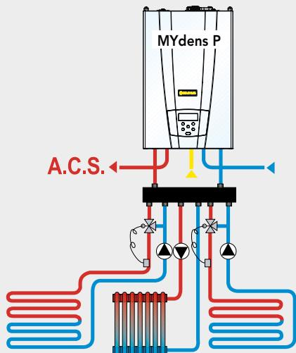
**MYdens**, in abbinamento al gruppo idraulico S.I.M. D, completo di separatore idraulico, può gestire allo stesso tempo fino a 3 circuiti di riscaldamento. Il dialogo con caldaia e sonda esterna permette il funzionamento a temperatura scorrevole.
