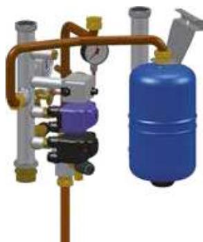
**ATTENZIONE:** il kit è completo di valvola di intercettazione del combustibile Ø1", pressostati di minima e di massima, valvola di sicurezza tarata a 3,5 bar, termostato di blocco, termometro, manometro completo di riccio e rubinetto, pozzetto ausiliare, raccordi da 1" 1/2, vaso di espansione da 5 litri.
